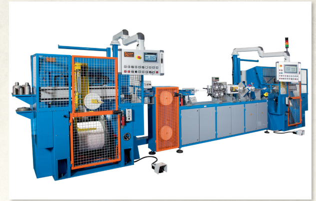
▲ Dieser komplett reversible Umwickelstand für die Kabelproduktion steht mittlerweile in acht Ländern. Er wird seit 14 Jahren produziert und stetig weiterentwickelt.
